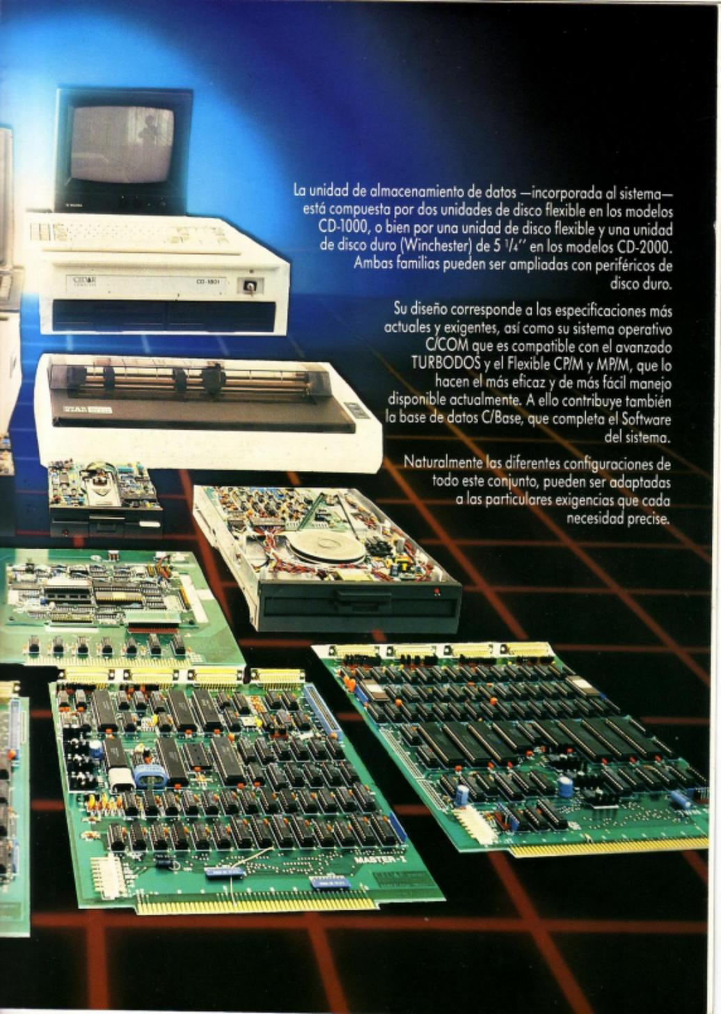
La unidad de almacenamiento de datos —incorporada al sistema— está compuesta por dos unidades de disco flexible en los modelos CD-1000, o bien por una unidad de disco flexible y una unidad de disco duro (Winchester) de 5 1/4" en los modelos CD-2000. Ambas familias pueden ser ampliadas con periféricos de disco duro.
